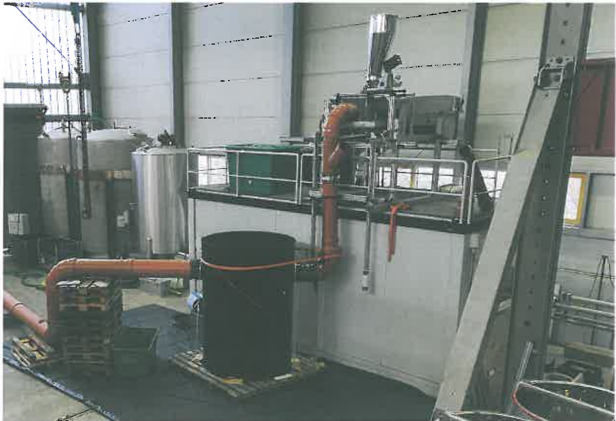
Abb. 1: Die aufgebaute Sedimentationsanlage Hydroshark DN1500 mit Zudosiereinheit und Probenahmestelle in der IKT-Laborhalle.
